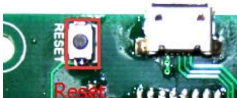
此键用于模块参数复位，在模块上电同时按下此键，并保存按下状态 2-3 秒，模块参数将复位为初始状态，一般操作会先按下 **Reset** 键再上电或按击 **RST** 键，并保存 **Reset** 键按下 2-3 秒完成模块参数复位。
