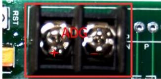
此接口用于测量电压，请正确连接被测信号线，并保证被测电压不要超过 12V。
