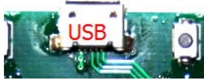
USB 接口用于模块和电脑通信，电脑可以通过此接口设置模块的相关参数配置，此接口是模块通过 CH340 芯片将 UART 转换成 USB，所以在使用 USB 接口前要安装相关的驱动软件，在使用时需选择正确的 COM 端口，并选择正确的通信方式速率（默认为 115200 波特率，8 为数据，无校验，1 位停止位）。
